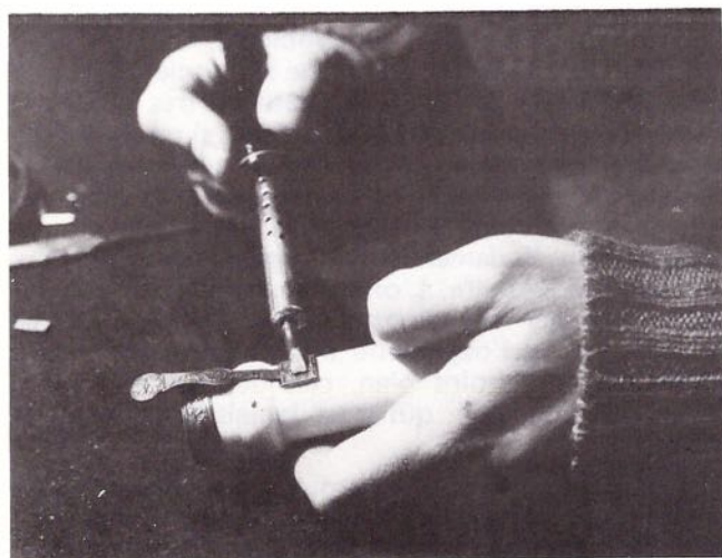
Figure 3 : Application du tampon collé à la gomme laque en chauffant la plaque de la clé avec un fer à souder.
